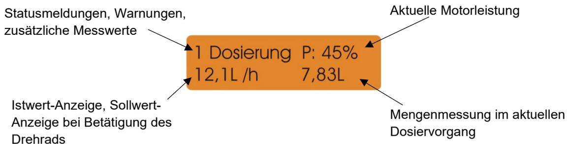
Durch Drehen des Knopfes kann die gewünschte Durchflussmenge vergrößert oder verkleinert werden. Die gewünschte Durchflussmenge wird bei jeder Bewegung des Rades für etwa 5 Sekunden angezeigt, danach die tatsächliche Menge. Bei aktiver Regelung wird die Motorleistung gesteuert, um den gewünschten Fluss einzustellen. Dabei ist zu beachten, dass mit der Kombination aus Pumpanlage, Düsen und Dosiermittel der eingestellte Wert auch erreicht werden kann.
